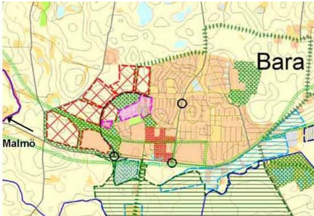
Svedala översiktsplan 2010. Utbyggnadsområden inom planperioden är markerade rödrutiga, utredningsområde blårandiga, skola och idrott rosa. Grön streckad linje anger två alternativa lägen för framtida spårväg mellan Malmö och Bara.
